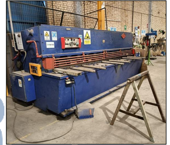
Cizalla de tres metros de longitud
